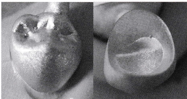
図1 評価項目の対象外とした鑄造体の気泡 ワックスの撥水性以外の要因においても発現するため評価の対象外とした。
