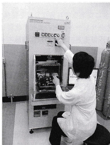
均一照射回転機構を内蔵した歯科用 低エネルギー電子線照射システム(明倫短期大学に設置)
