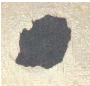
図12 底穴の辺縁の一例 (試料No. 7) 底穴の形状が真円ではない。
