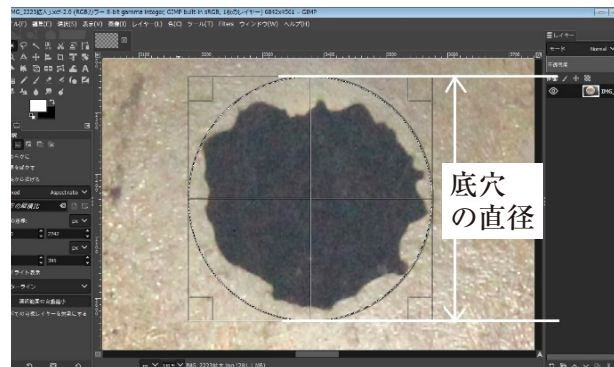
図10 図9の底穴部分の拡大図 辺縁と最も多くの点で接触する補助円を描記し、その直径から、中心点と半径を導く。
