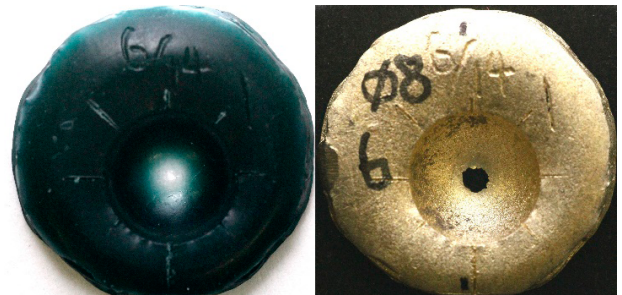
図14 ワックスパターンとメタルパターンの比較の一例 (試料No. 6)
