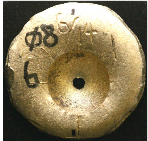
図6 鋳造体の一例（試料No. 6） 全ての鋳造体の圧痕中心部に未鋳造の穴が開く。
